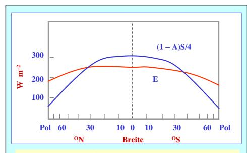
Jahresmittelwerte für die am Oberrand der Atmosphäre einfallende solare Strahlung (1-A)S/4 und emittierte terrestrische Strahlung E in Abhängigkeit von der Breite.
