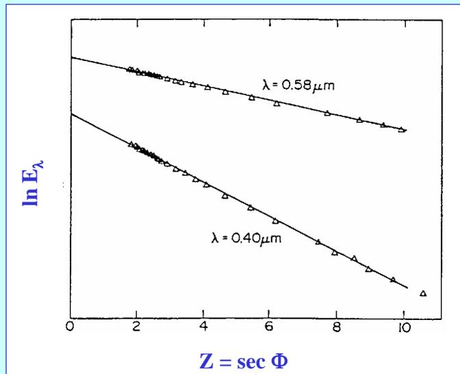
Spektrale Bestrahlungsstärke der solaren Strahlung, gemessen am Boden bei ungehinderter Einstrahlung und gleichbleibenden atmosphärischen Bedingungen (Langley-Plot).
