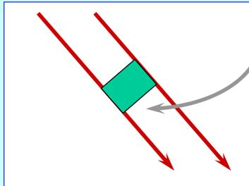
Querschnittsfläche die die Teilchen in einem Einheitsvolumen senkrecht einfallender Strahlung zur Verfügung stellen.
