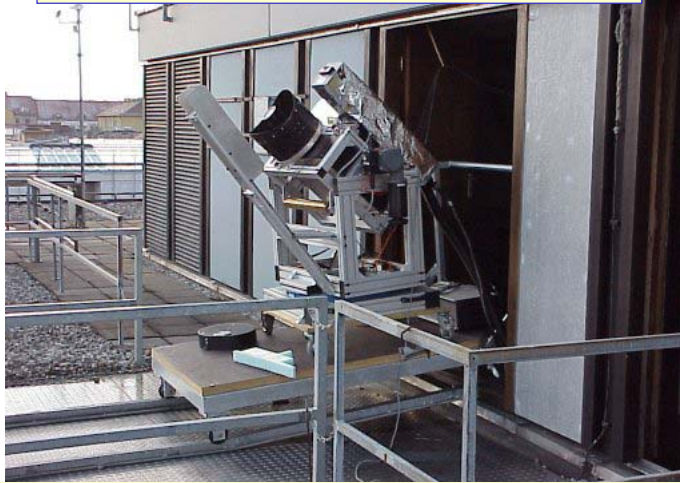
Mobil, schwenkbar, drei Wellenlängen, zwei Teleskope
