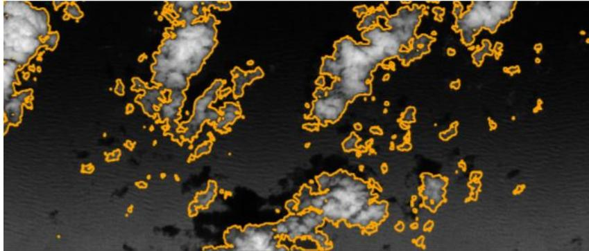
Abbildung 3.3: specMACS SWIR Daten-Ausschnitt mit farbigen Konturen der Wolken, die von specMACS detektiert wurden
