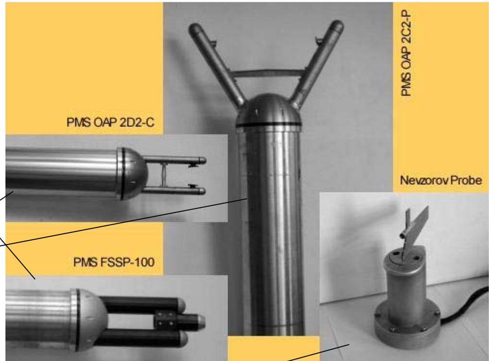
**Nevezorov Sensor** misst Flüssig-/Eiswasserdichte: zwei „heiße Drähte“ fangen Tropfen/Eiskristalle ein und ermitteln über die Energie, die zur Verdunstung notwendig ist die Massendichte
